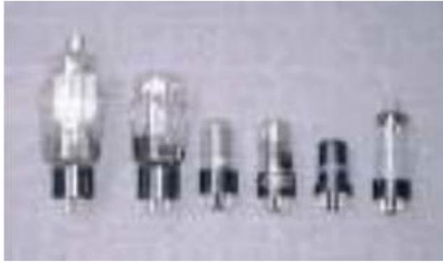
**Gambar 1.3** Tube vakum pada komputer generasi pertama
